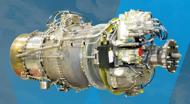
WZ16发动机是一款1300千瓦级涡轴发动机,于2019年10月和2021年3月分别取得 中国民航局颁发的型号合格证(TC)和生产许可证(PC)。WZ16发动机首装航空工业 AC352直升机。该发动机可用于3吨级单发、6-8吨级双发和13吨级三发直升机或旋翼无人 机,也可用于飞艇、多电飞行器等其他平台。
