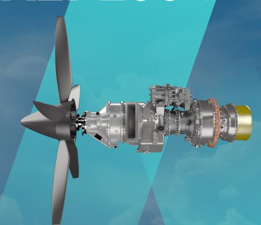
AEP100发动机是在AES100发动机基础上发展的一款900千瓦级拉进式涡桨发动机,计 划2025年12月取得中国民航局颁发的型号合格证,可配装6吨级通用飞机或3~10吨级无人 机,应用于支线物流和短途客运。
